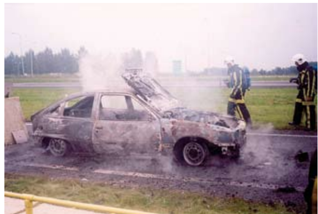
De duurzaamheid van het asfalt wordt getest middels een autobrand.
