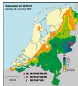
figuur 5: instortingen en blijvende vervorming van daken (totaal aantal)
