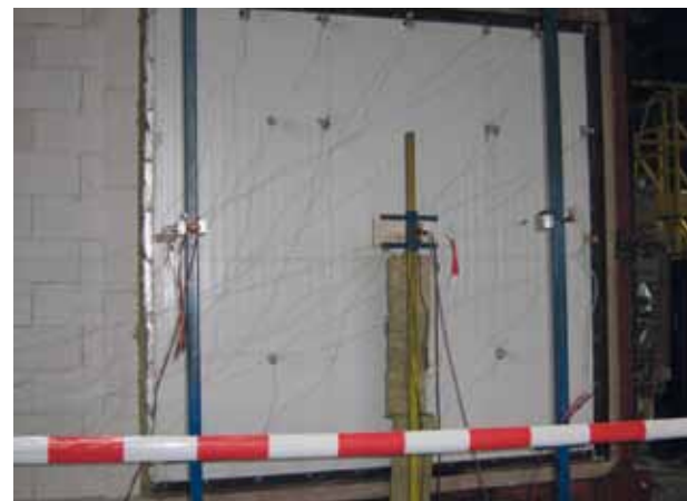
Test ColdStore paneel met een dikte van 175mm bij Efectis in maart dit jaar waarop meer dan 60 minuten werd gehaald.
