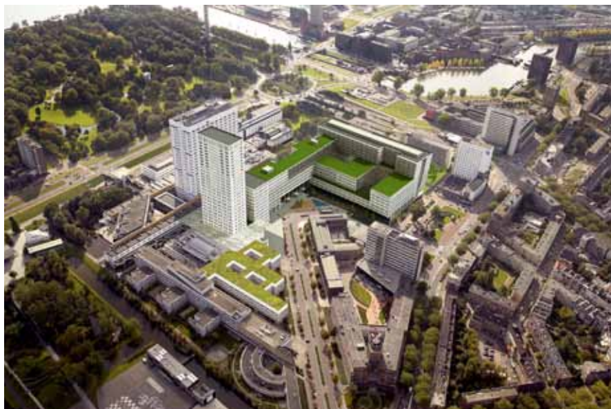
Het Erasmus MC-Sophia Kinderziekenhuis en op de achtergrond de nieuwbouw van het Erasmus MC in vogelvlucht, samen goed voor zo'n 15.500 vierkante meter vegetatiedak. Op de voorgrond de langgerekte Sophia Kliniek, hier nog zonder groendak.
