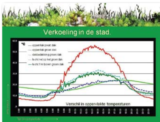
De rode lijn is het temperatuurverloop op een kaal zwart dak tijdens een zomerse dag. Tussen 13 en 14 uur nadert de temperatuur 60^\circ \text{C} . De blauwe strippellijn is de temperatuur net boven een groendak. Op hetzelfde tijdstip schommelt hier de temperatuur tussen 20 en 25^\circ \text{C} .
