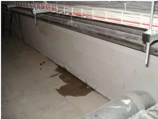
Lekkagewater zichtbaar na besproeiing aan de binnenzijde van de gevel.
