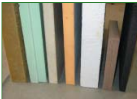
Voorbeelden van traditionele isolatiematerialen'. Vlnr: steenwol, geëxtrudeerd polystyreen, polyurethaanschuim, fenolformaldehydschuim, geëxtrudeerd polystyreen, perlietboard en CG.
