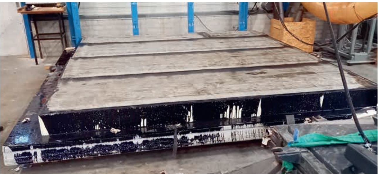
Voor de windkisttest is het hele pakket opgebouwd op de testlocatie van Kiwa BDA.
