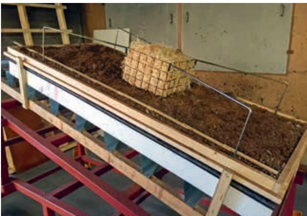
Testmethode NTA 8292 extensief begroeide daken door Kiwa BDA Testing.
