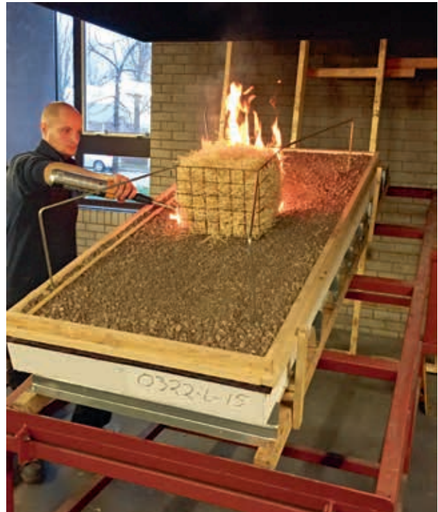
Houtwol in een metalen korf wordt ontstoken op het te testen element.
